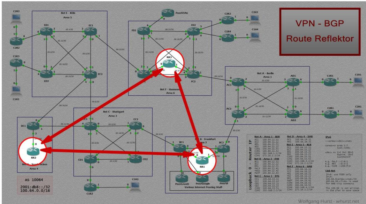
Wir werden nun den Route Reflektor einrichten. Dazu werden wir den RR so konfigurieren, dass jeder RR den anderen RR als Nachbarn hat, damit wird eine entsprechende Verteilung sichergestellt. Weiterhin konfigurieren wir die Clients (PE Router) damit sie den RR benutzen können.
