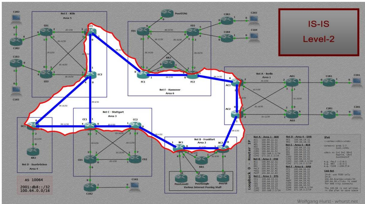
Auf jedem Core Router sind die Nachbarn jeweils auf dem Interface 0 und 1 angebunden. Bis auf die beiden Ausnahmen EC2 und CC1, da hängt noch einer am Interface 4. An diesen Interfaces müssen wir explizit den IS-IS Typ festlegen, weil sonst funktioniert es nicht.
