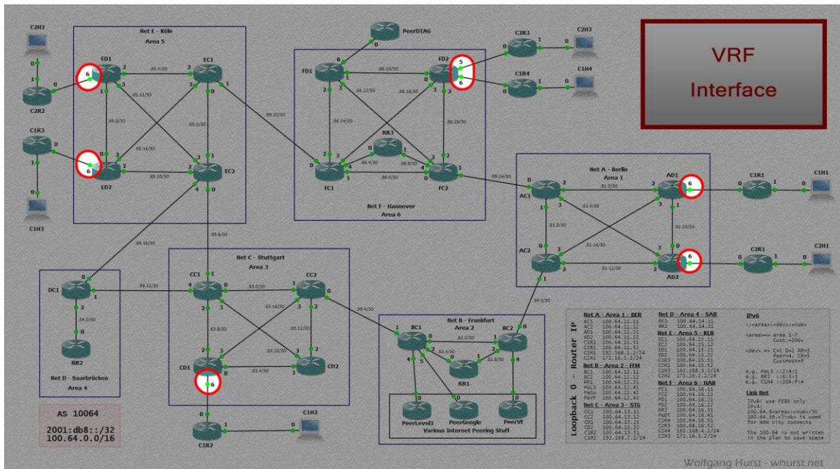
Nun geht man auf das Interface wo der Kunden angebunden ist. Man wirft das Interface in den Virtuellen Router und konfiguriert die Linknetz IP. Wie schon angedeutet verwende ich überall das 10'er.
