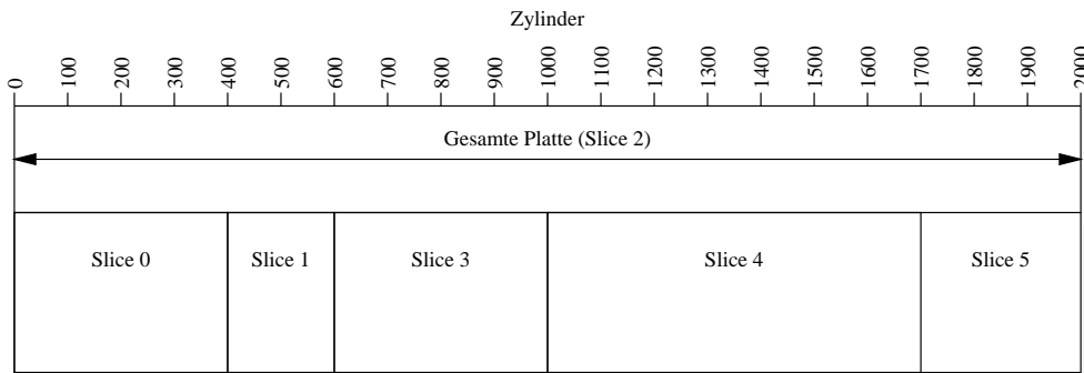
Abbildung 19.1: Einteilung eines Laufwerkes in Slices
